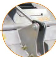
**Задний щиток с гидравлическим приводом**
