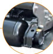
**Самоочищающийся опорный ролик со встроенными салазками**
