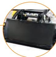
**Саморегулирующаяся планка для навесных приспособлений быстрого крепления** для работы на любой местности
